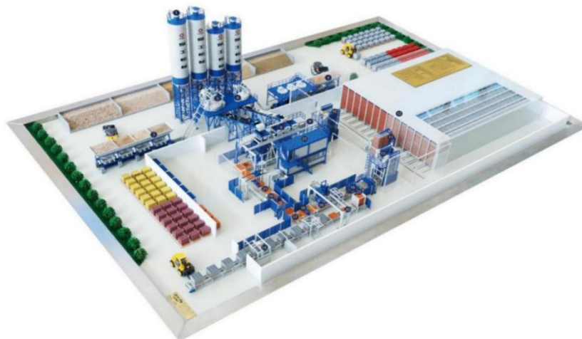
图 2-2 生产车间内设备布局图
