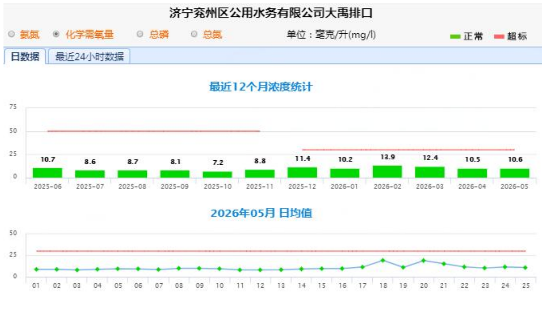
图 4-3 兖州大禹污水处理有限公司化学需氧量排放情况（COD \leq 30\text{mg/L} ）
