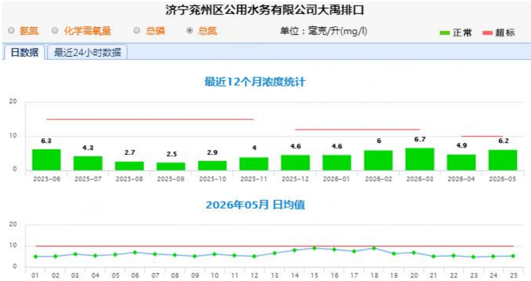
图 4-5 兖州大禹污水处理有限公司总氮排放情况（总氮 \leq 10\text{mg/L} ）
