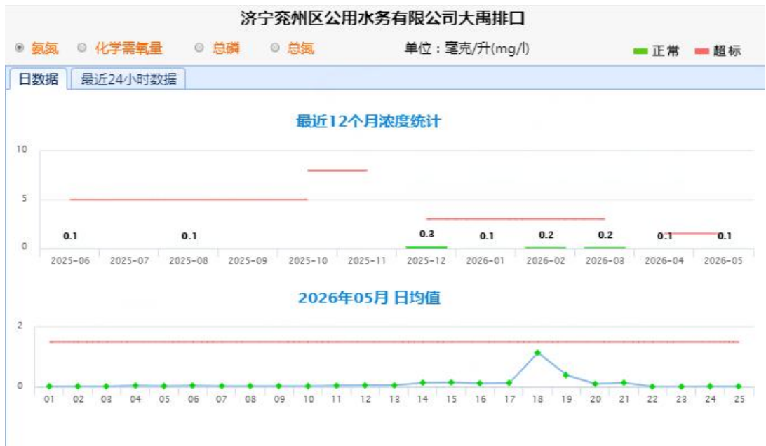
图 4-2 兖州大禹污水处理有限公司氨氮排放情况（氨氮 \leq 1.5\text{mg/L} ）
