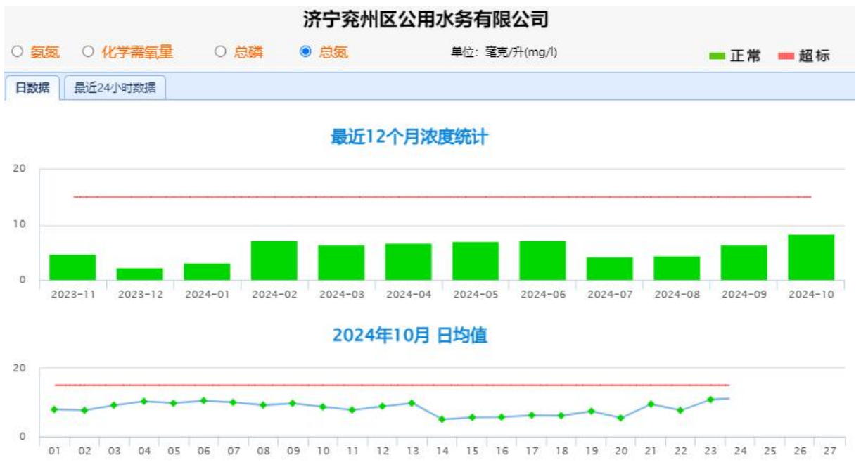
图 4-5 济宁兖州区公用水务有限公司（兖州大禹污水处理厂）总磷排放情况
