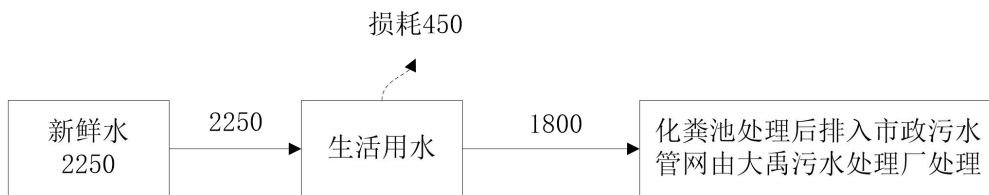
图 2.2-3 二期工程水平衡图（单位：m 3 /a）
