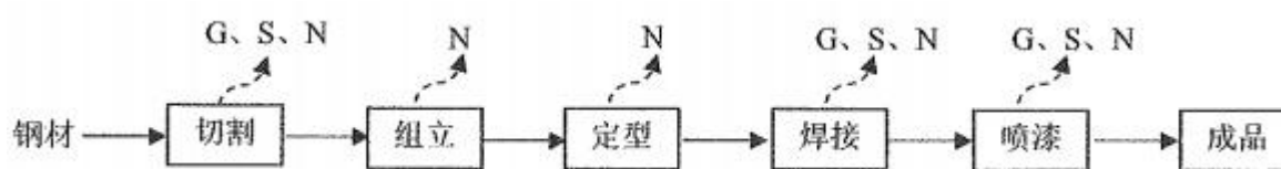
图 2-4 钢结构生产工艺流程及产污环节图
