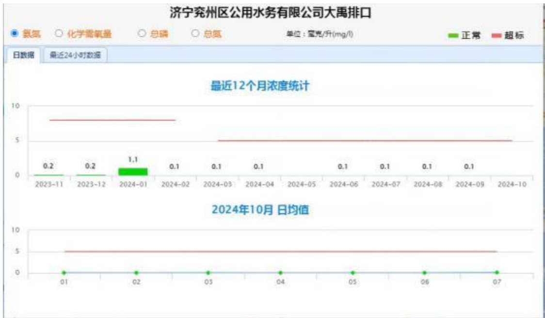
图 4-3 大禹污水处理厂最近 12 个月氨氮浓度统计情况
