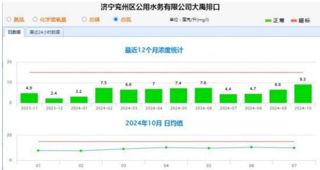
图 4-6 大禹污水处理厂最近 12 个月总氮浓度统计情况
